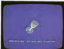
Al igual que la ampliación, H-3D permite también la reducción de la imagen dibujada.
